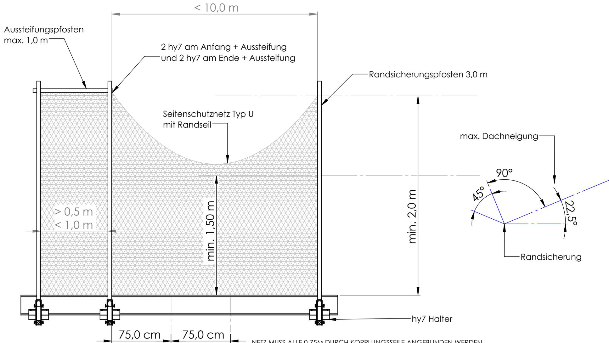
NETZ MUSS ALLE 0,75M DURCH KOPPLUNGSSEILE ANGEKÜPFT WERDEN.
